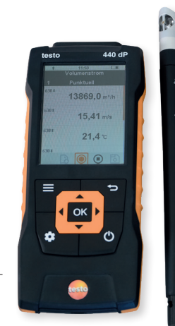
Messung Lüftungsanlagen Überprüfung Luftströme in Lüftungsanlagen
