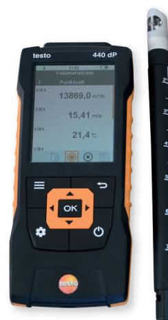
Messung Lüftungsanlagen Überprüfung Luftströme in Lüftungsanlagen
