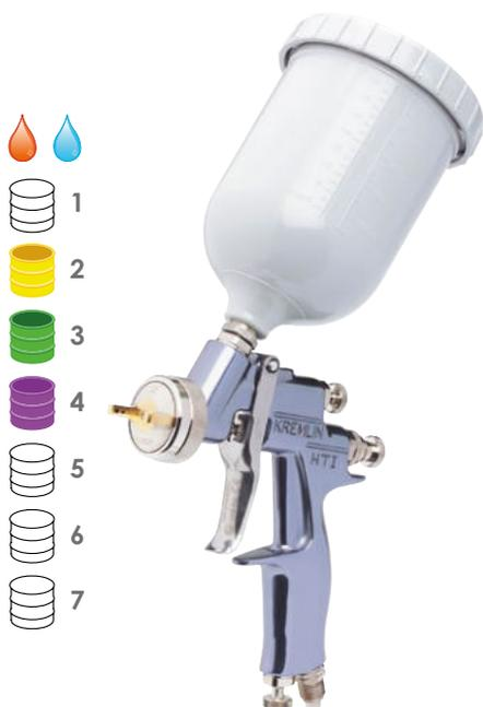
Die M22 G HTi ist eine Spritzpistole mit Fließbecher, die eine hervorragende Oberflächenqualität und hohe Übertragungseffizienz mit einem ausgezeichneten Bedienkomfort kombiniert. Erhältlich mit einem von 2 verfügbaren Zerstäuberköpfen: EP5 für schwer zu zerstäubende Beschichtungen wie Materialien mit hohem Feststoffanteil oder Materialien auf Wasserbasis oder E5 K HVLP zur Optimierung der Effizienz und HVLP-konformem Airspray.
