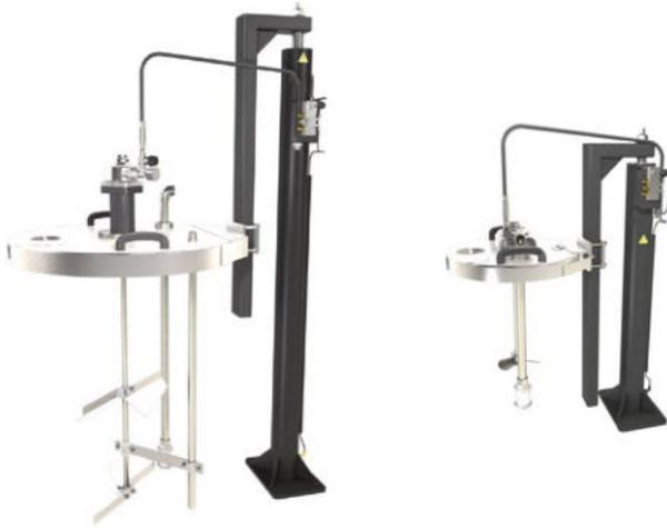
Dieses Rührwerk für 20-, 40- bis 200-Liter-Behälter verfügt über eine doppelwirkende Hebevorrichtung zum schnellen Anheben eines Edelstahldeckels, der für einen schnellen Fasswechsel ausgelegt ist. Der Deckel ist mit einem motorisierten Rührwerk mit Flügeln für niedrigviskose Materialien und einem Edelstahlrohr ausgestattet.
