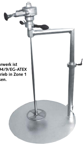
Ringpropeller-Rührorgan, ø 140 mm
