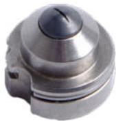
Die Auswahl der richtigen Düse ist ausschlaggebend für eine hochwertige Oberflächenqualität sowie die gleichzeitige Reduzierung des Lackverbrauchs. Sie hat entsprechend dem gewünschten Durchfluss zu erfolgen. Um die hohe Übertragungsrate konstant zu garantieren, muss eine Airmix®-Düse regelmäßig ausgetauscht werden.
