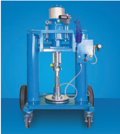
Hubwagen Rammpressen mit Regeleinheit und automatischer Abschaltung
